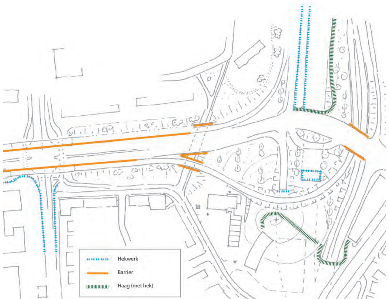
Afscherming rand rond tunnelmond Noord: hagen waar genoeg ruimte is; elders hekwerk/barrier.
